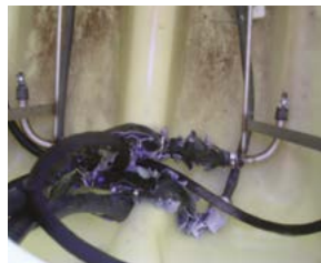
Засорение шлангов опрыскивателя
